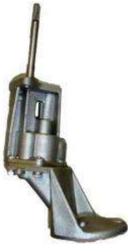
bomba aceite motor Renault cleon atmosférico (SISTEMA ENGRANAJES)
